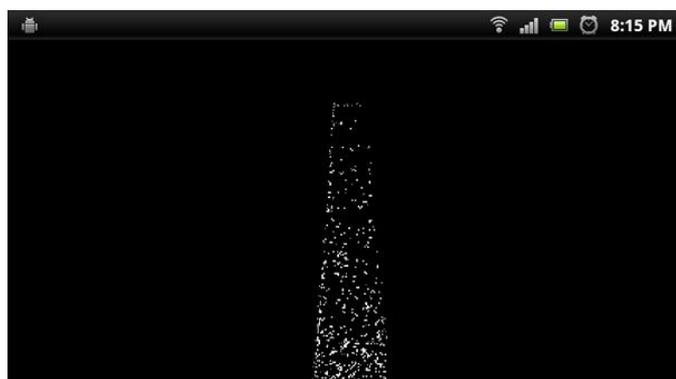
Figura 8 - O retorno do método `inRange` é uma imagem binarizada, com as cores no padrão HSV.
