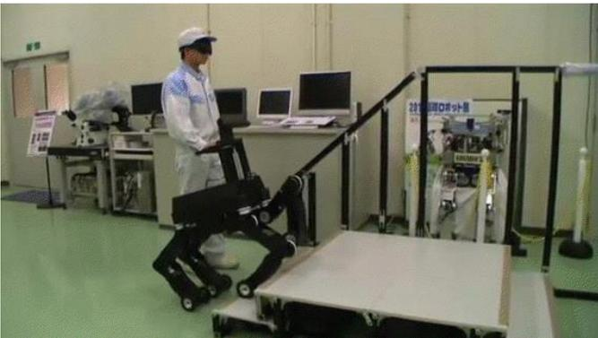
Figura 2 - O robô da empresa NSK, capaz de identificar escadas e guiar pessoas com deficiência.
