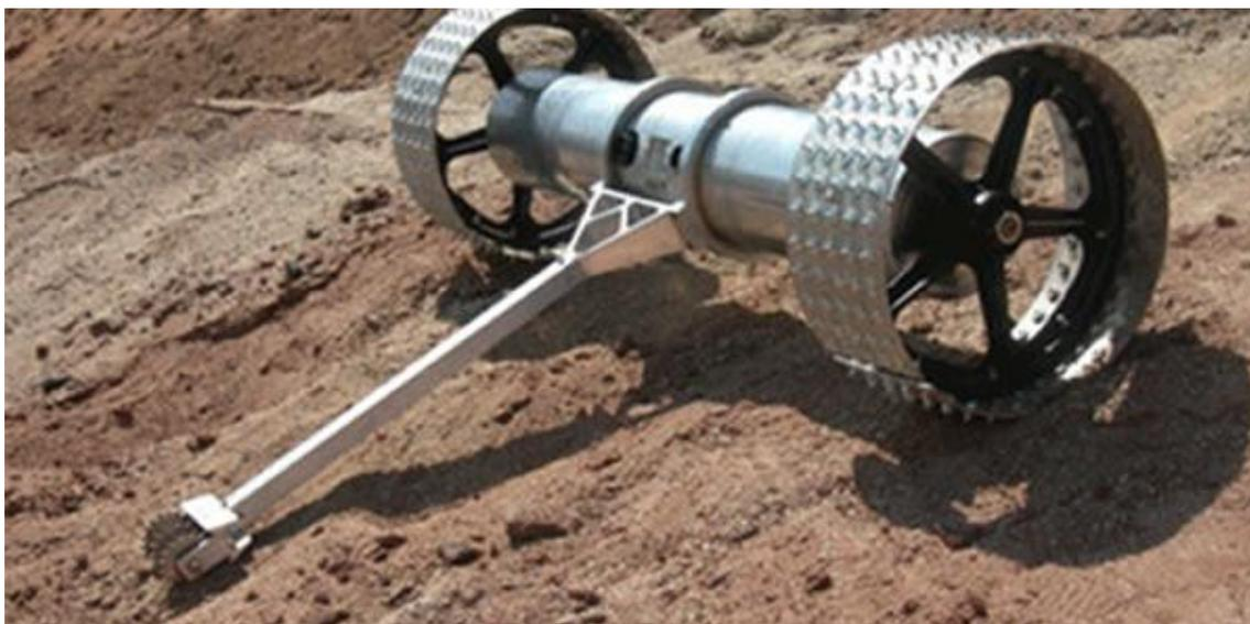
Figura 9 - O Axel Rover, desenvolvido pela NASA para maior versatilidade na locomoção dos terrenos de Marte (<http://www-robotics.jpl.nasa.gov/roboticImages/img811-413-browse.jpg>).
