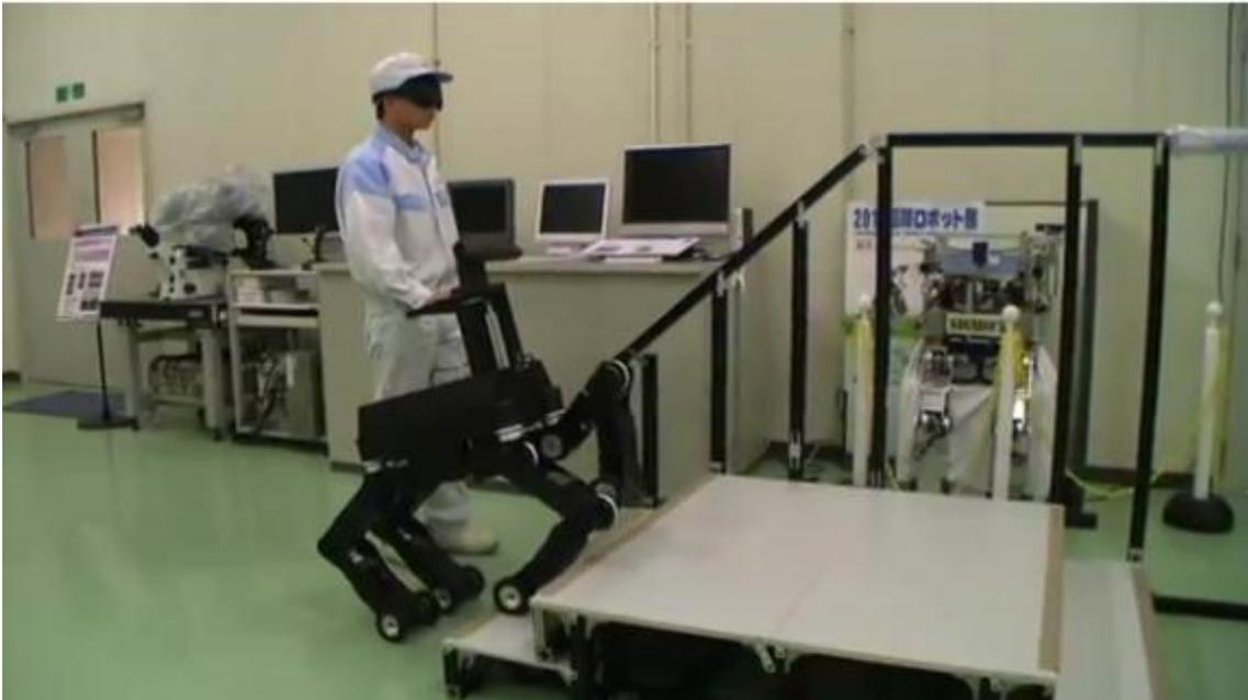
**Figura 2 - O robô da empresa NSK, capaz de identificar escadas e guiar pessoas com deficiência visual ([www.nsk.com](http://www.nsk.com)).**
