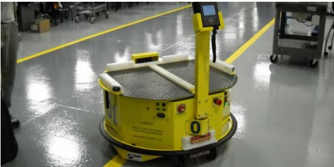
**Figura 14 - Exemplo de robô AGV, que utiliza referência óptica para locomoção**
