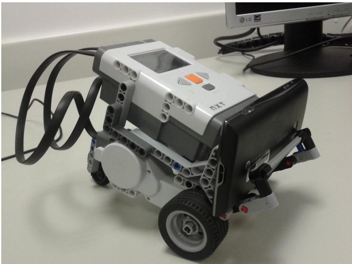
Figura 27 - O celular ficará a frente do robô, captando suas imagens e as processando para determinar suas ações.
