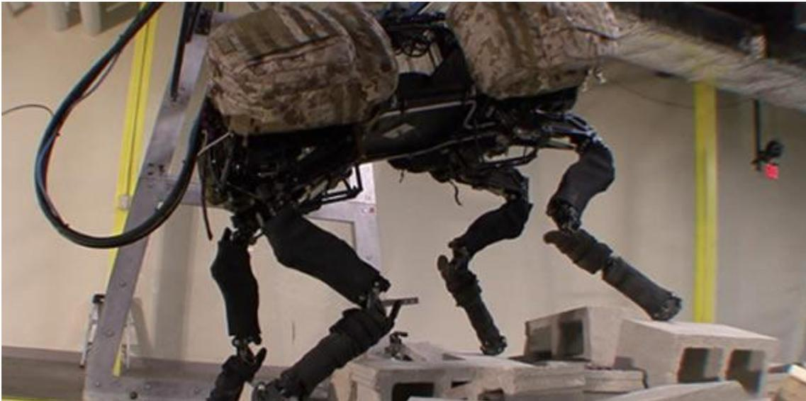
Figura 12 - O BigDog é um exemplo de robô quadrúpede, usado para carregar equipamentos militares ([http://www.bostondynamics.com/img/BigDog\\_ClimbRubble.png](http://www.bostondynamics.com/img/BigDog_ClimbRubble.png)).
