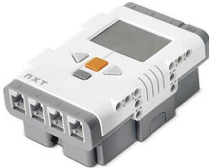
**Figura 18 - O componente "Brick", responsável pelo controle lógico do robô NXT (<http://www.nxt8547.org/legonxt.jpg>).**
