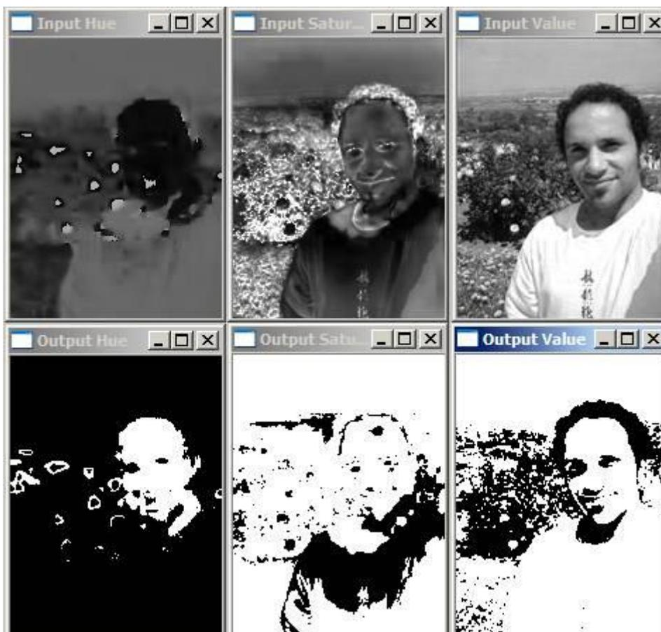
Figura 22 - O uso do padrão HSV permite dividir melhor as cores em uma imagem (<http://www.shervinemami.info/blobsSkinDetector.jpg>).
