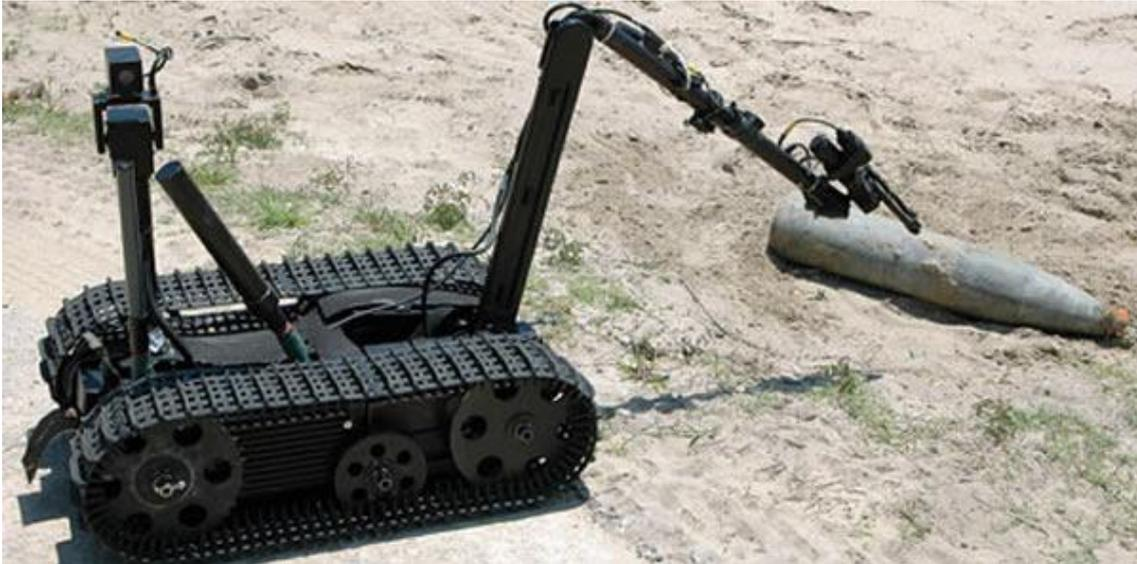
Figura 10 - O EOD-Robot é um exemplo de robô com esteira, construído para poupar vida de soldados em batalha ([http://www.almc.army.mil/alog/issues/MayJun08/Story\\_Images/ms435\\_imageN.jpg](http://www.almc.army.mil/alog/issues/MayJun08/Story_Images/ms435_imageN.jpg)).
